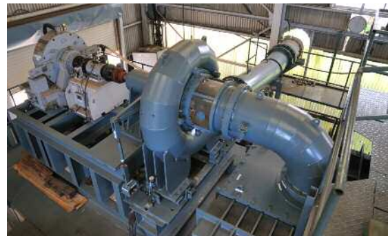
上から/水中タービン発電機の汎用性の高さを表現したイラスト。1.ベンストック(薄水管)(落差6~20m) 2.分岐管(落差6~20m) 3.傾斜管据え付け(落差6~20m) 4.サイフォン(落差6~20m) 5.開水路スルースゲート(落差5~10m) 6.タンDEM(1水槽2台)据え付け(落差3~10m) 7.開水路シンダーゲート(落差3~6m) 8.地下式水車室(落差3~6m) 9.コンクリートサイフォン(落差2~5m) /構造がよくわかるように、敷地内に置かれたフランス水車/左:試験設備/右:クロスフロー水車
