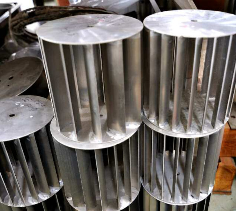
上右：風車から水車に展開するきっかけとなった装置／上左：羽根の角度、枚数、幅など、さまざまなタイプを試して最適なモデルを検証した／下：実験装置。
