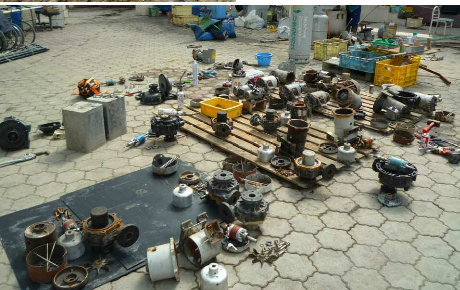
津波の被災直後のマリンピア松島。松島湾にあるたくさんの島が津波を抑えてくれたのだが、それでも泥や漂流物が流れ込み、売店のガラスが割れて商品などもすべて流されたという。配管類は泥に埋没したのを掘り起こし分解して熱湯で洗い、乾かしてから組み立て直した。電気に強い西條館長の指揮の下、普段から自分たちでメンテナンスを手がけてきた経験が役立つた。
