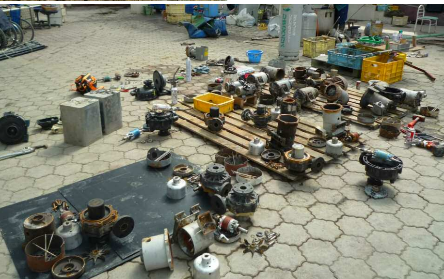
津波の被災直後のマリニピア松島。松島湾にあるたくさんの島が津波を抑えてくれたのだが、それでも泥や漂流物が流れ込み、売店のガラスが割れて商品などもすべて流されたという。配管類は泥に埋没したのを掘り起こし分解して熱湯で洗い、乾かしてから組み立て直した。電気に強い西條館長の指揮の下、普段から自分たちでメンテナンスを手がけてきた経験が役立つた。
