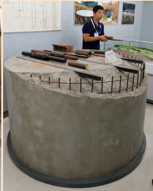
下：コンクリートと鉄筋で固められた深礎工の実物大模型。上に乗っている太い鉄筋が使われている。 左中：排水トンネル内部を見学。 左上から：トンネルの一部を窓抜きにして、偶然発見された地滑り面を見せている／関西本線 亀の瀬隧道跡。
