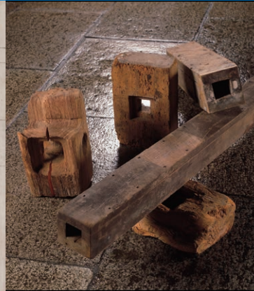
樽でつくられた木製の水道管と継手 いずれも招鶴亭文庫蔵
